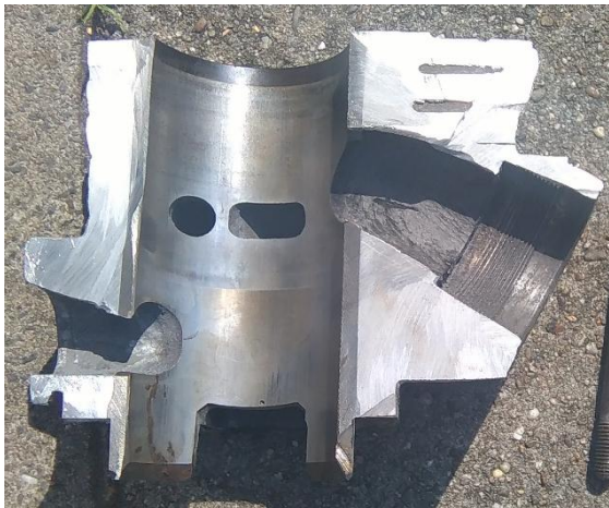
Foto: een doorgezaagde ETZ 250 cilinder
